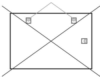
**2** Suspendre le produit au système de suspension prévu. Le dispositif de suspension est prémonté. Merci de ne pas relier les fixations murales avec une ficelle ou un fil métallique, et de ne pas suspendre le cadre au milieu à l'aide d'un seul crochet!
