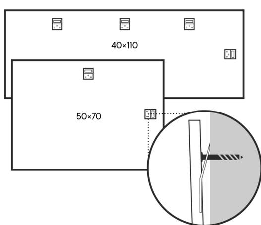
**3** Le type de fixation dépend du matériau du mur. Veuillez utiliser des crochets et des chevilles adaptés à la nature du mur. Celles-ci sont vendues séparément et ne font pas partie de la livraison.
